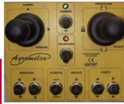
Os movimentos e a vibração realizam-se de forma muito cômoda e simples, por intermédio de uma caixa eletrónica equipada com joysticks e seletores.
