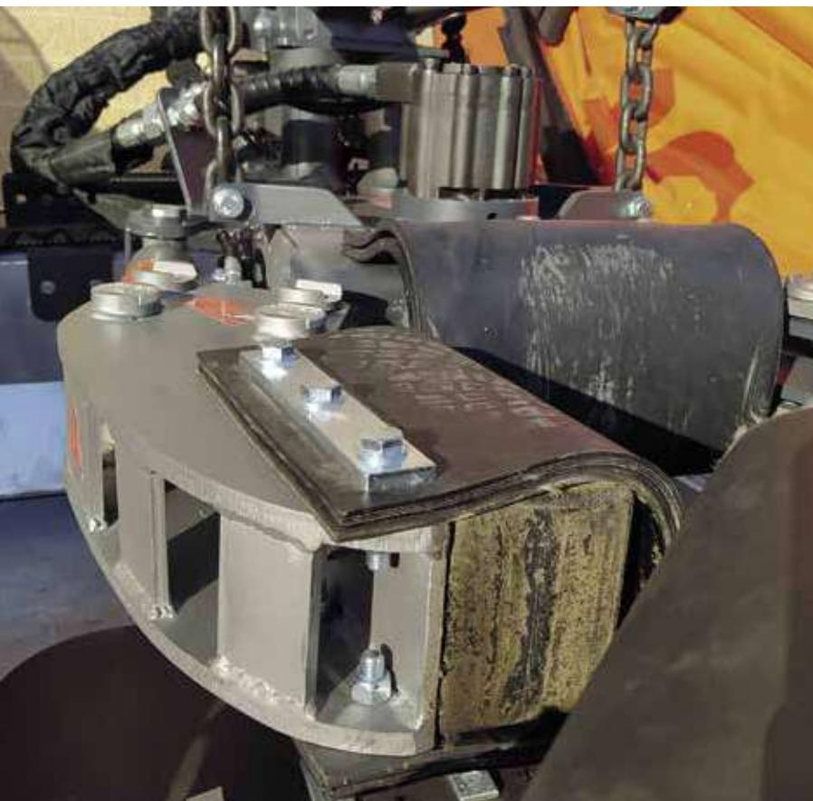
**A scelta**, possiamo montare i bracci generici, che permettono di eseguire perfettamente le vibrazioni di tronchi che oscillano tra gli 8 e i 45 cm. La vibrazione ottenuta e i risultati di caduta saranno eccellenti.
