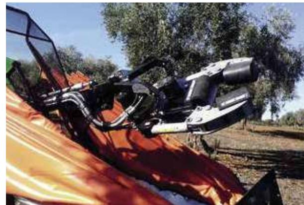
Questo sistema di vibrazione è stato progettato principalmente per la raccolta di alberi di 1 piede con grande facilità e rapidità. Il modello VM1, permette sollevare ed estendere il telescopio per eseguire l'aggancio in posizioni più elevate. In casi necessari, quando gli alberi presentano difficoltà per la raccolta con l'ombrelllo, è possibile sganciarlo con somma facilità.
