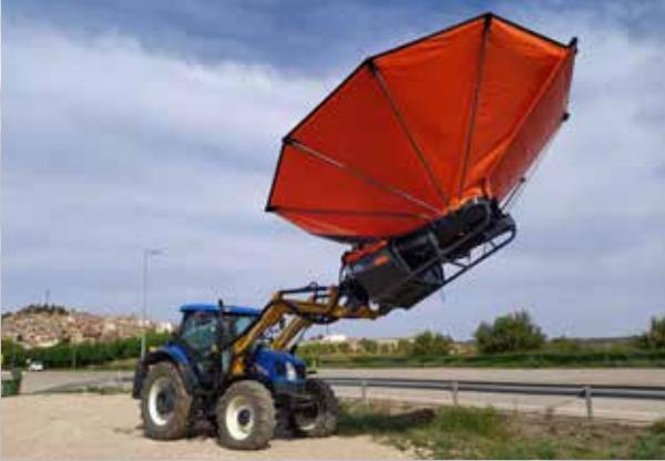
Nuestros equipo de vibración **VMS** va equipado con la nueva plataforma tubular de hierro.
